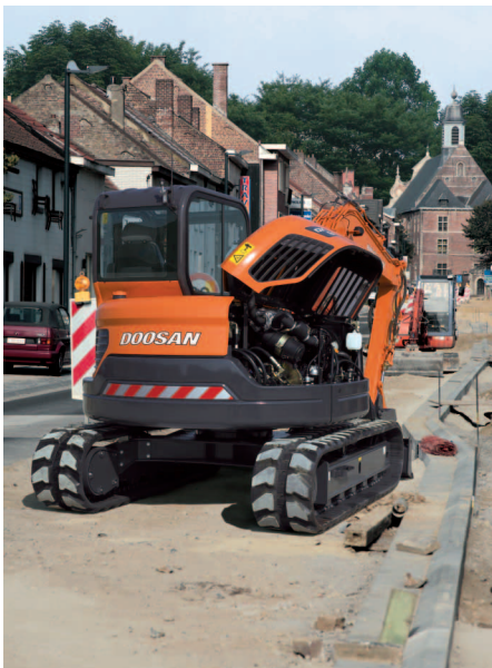
Manutenzione semplice: l'accesso alle varie parti del motore avviene di fianco
