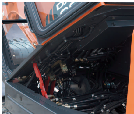
Cabina inclinabile per una facile manutenzione
