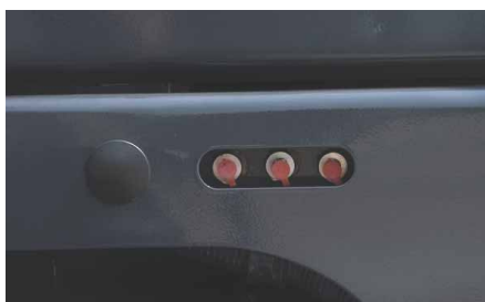
Condotti di lubrificazione: sono integrati per una facile manutenzione della valvola e del cilindro
