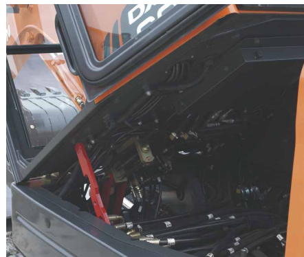
Cabina inclinabile per una facile manutenzione
