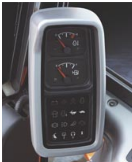
Pannello di strumentazione di tipo fisso
