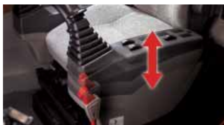
Regolazione in altezza della console comandi
